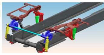
L'innovazione tecnica abbinata ad una nuova geometria delle sospensioni cabina assicurano il massimo comfort di guida e consentono, grazie alla regolazione del precarico, di avere una risposta personalizzata alle condizioni di impiego del veicolo.
